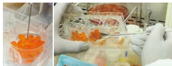
サケ科魚類の卵の保菌検査。卵の一つずつ針で穴を開けて検査をします。
