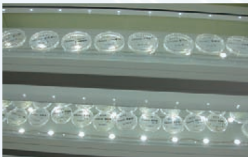
写真2. LEDを付けた保存培養棚での寒天平板培地による保存
