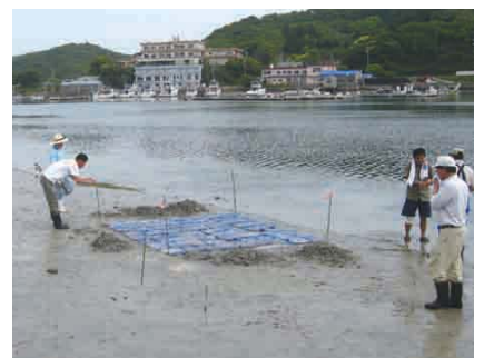
写真3. カキ殻加工固形物を利用した実験を行った海岸と網袋の設置状況
